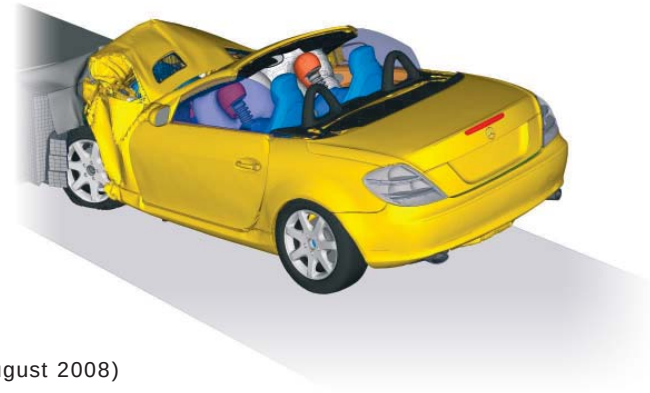
Berechnung eines Fahrzeugaufpralls mit LS-DYNA
