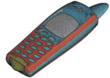
Falltestsimulation mit LS-DYNA
