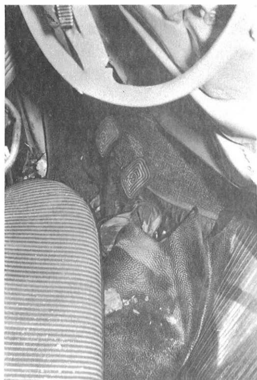
Photo 2 - Vue du pédalier (on peut remarquer les chaussures de la conductrice coincées entre les pédales)
