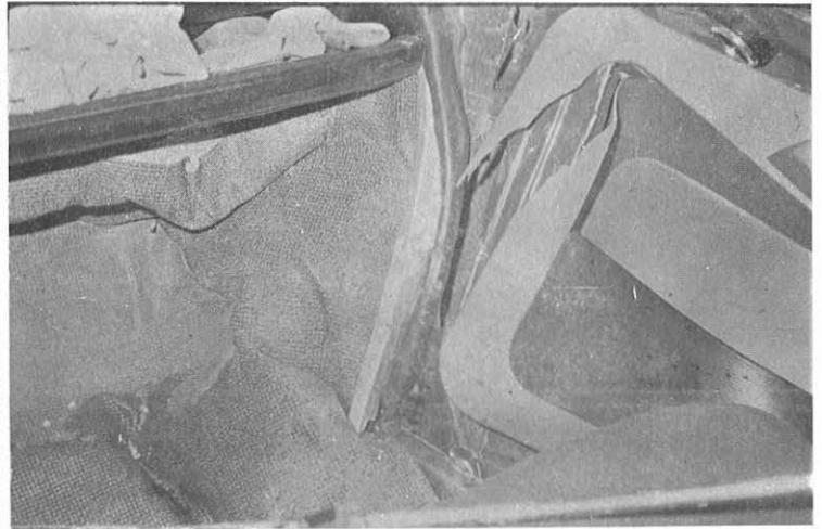
Photo 6 - Déformation du plancher en face du passager avant.
