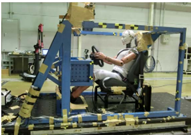
Fig. 8. Sled test apparatus.
